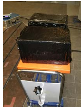
Wrapping the blocks in PE film
