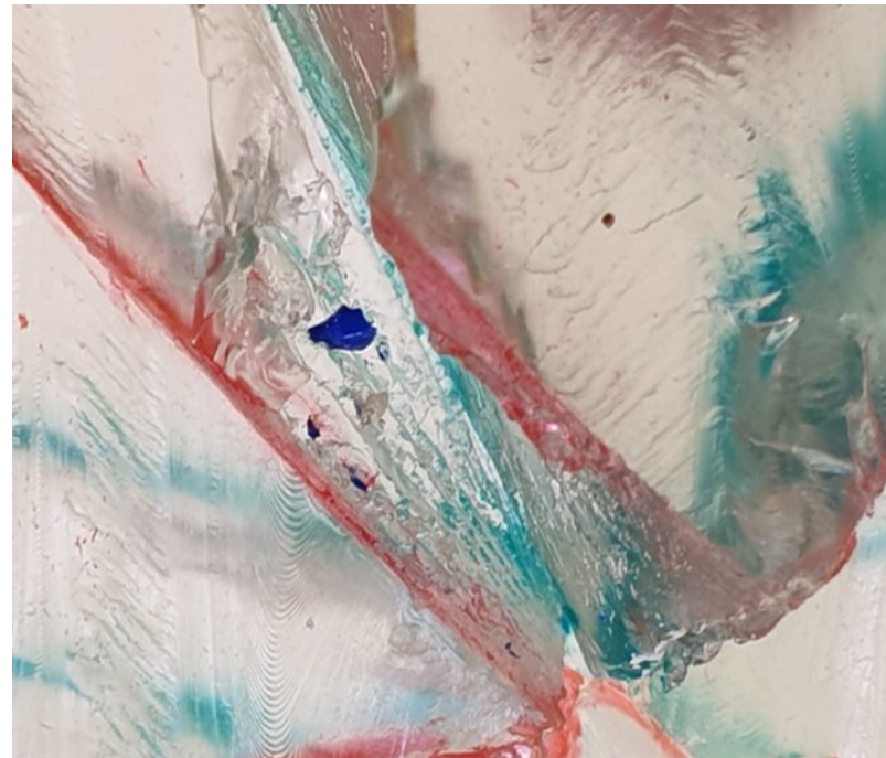
Abb. 2: Darstellung der Eindringtiefe in Abhängigkeit der Zielgeschwindigkeit der Diabolos und der Stahlrundkugeln (BB's) in Seife nach Permatin-Rezeptur
